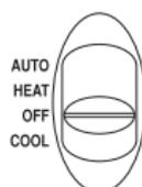
4. Coloque el interruptor AUTO-HEAT-OFF-COOL en la posición HEAT (calefacción).
