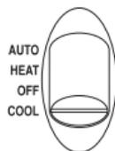
**NOTA:** SI SE APAGA EL TERMOSTATO CUANDO SE ENCUENTRA EN EL MODO COOL, LA DEMORA PREESTABLECIDA DE 5 MINUTOS EVITARÁ QUE EL SISTEMA SE ENCIENDA DE NUEVO. ESTO PROTEGE AL COMPRESOR. NO SE REQUIERE UN RELEVADOR DE DEMORA ADICIONAL. PARA PASAR POR ALTO LA DEMORA DE 5 MINUTOS DURANTE LA INSTALACIÓN, OPRIMA EL BOTÓN DE RESTABLECER.
